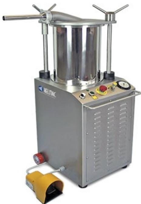
La macchina è dotata di centralina idraulica che gestisce il movimento del pistone. La velocità di salita è regolabile per avere la possibilità di insaccare qualsiasi tipo di prodotto. Dotata di manometro per verificare la pressione.
